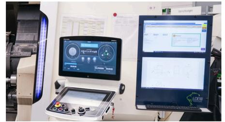
Aujourd'hui, chaque machine est équipée de deux moniteurs, l'un au-dessus de l'autre - une conception interne de LOEW. Le logiciel MES FLEX de FORCAM ENISCO fonctionne sur le moniteur supérieur, fournissant des données sur chaque processus de travail en temps réel. Sur l'écran inférieur, l'opérateur voit le dessin de la pièce.
