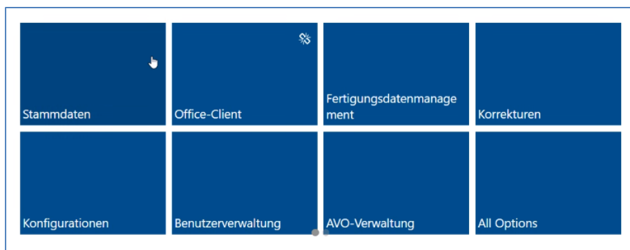
Abbildung 11: der Workbench-Client enthält das Management von Arbeitsplätzen, Arbeitsvorgängen, die Stammdatenverwaltung, Vergabe von Rechten und Rollen, und deren Konfigurationsmöglichkeiten.
