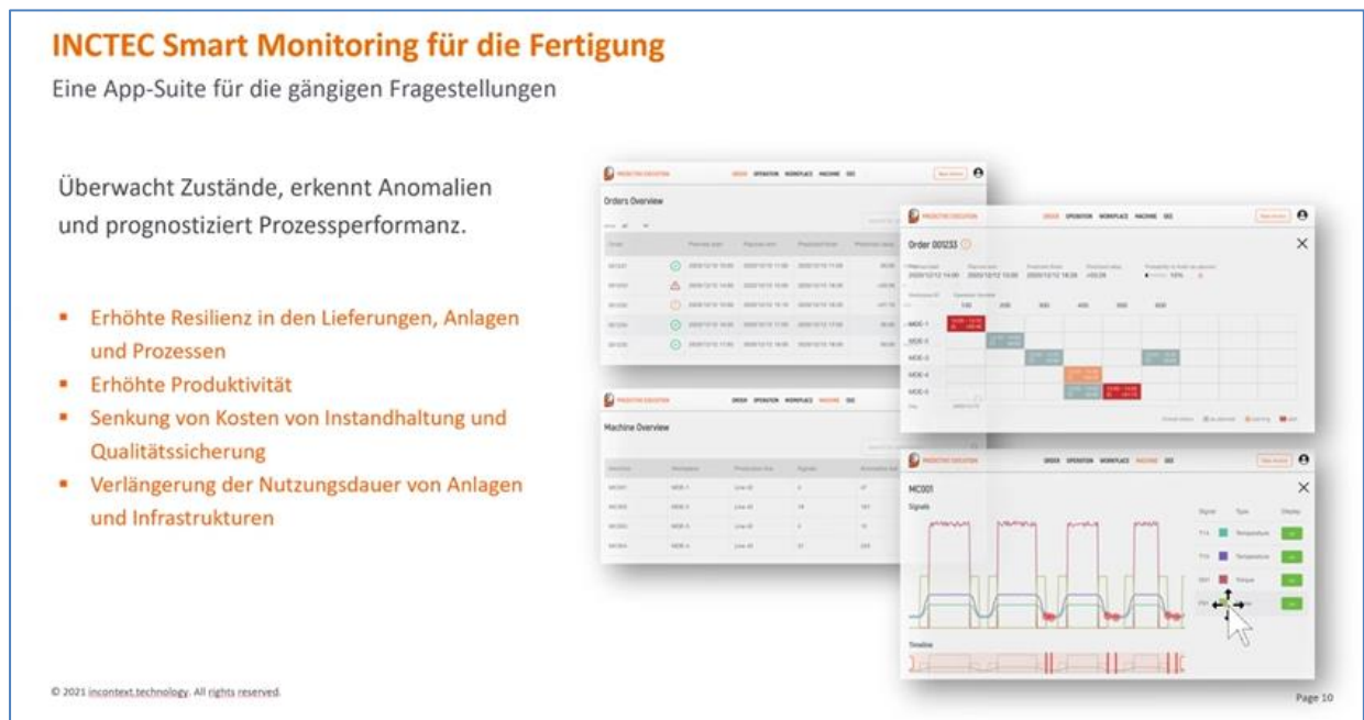
Abbildung 33: Das Beispiel für das Modul INCTEC Smart zeigt detaillierte Auswertung von erfassten Prozessdaten, die über KI-Module in der Lage sind Qualitätsanomalien vorherzusagen (Dieses Modul ist nicht im Standardumfang von FORCAM FORCE enthalten)
